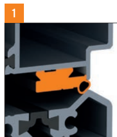
DODATKOWA USZCZELKA EPDM USZCZELNIA POŁĄCZENIE SKRZYDŁA Z PROGIEM
